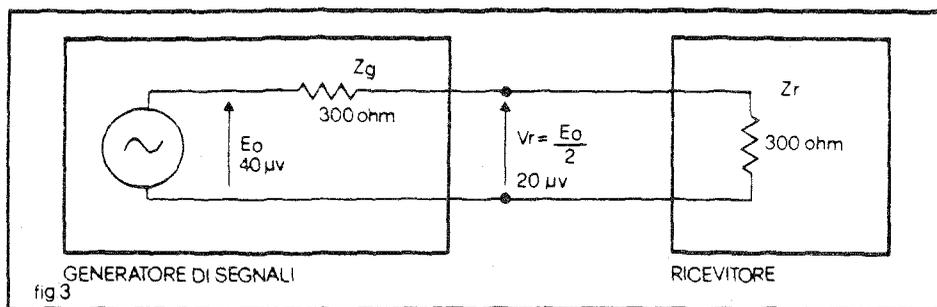
Figura 3. Secondo quanto prescritto dalle norme CEI 173 e dalle norme IHF/IEEE, bisogna fare riferimento alla forza elettromotrice  $E_0$  del generatore e non alla tensione  $V_r$  ai morsetti di antenna del ricevitore. Le vecchie IHF e le DIN 45500 dicono esattamente il contrario. Nel calcolare la potenza disponibile bisognerà però tenere conto in ogni caso della tensione ai morsetti di antenna.
